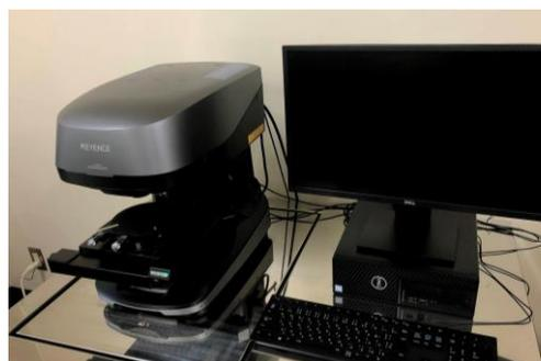
図 1. 表面形状解析レーザー顕微鏡
