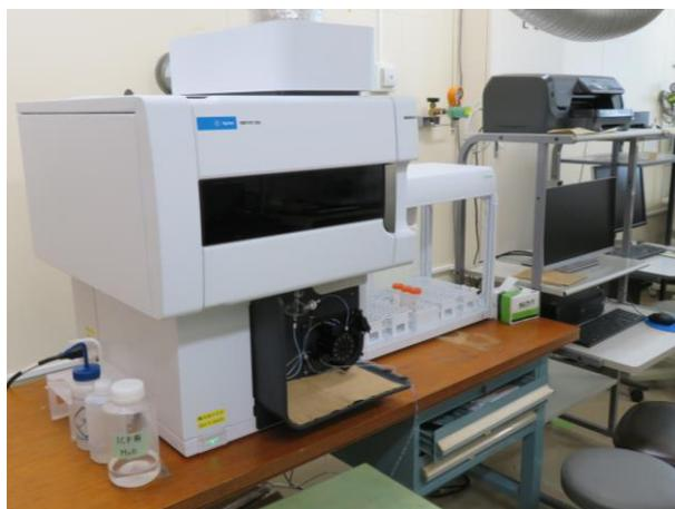
図 1. 誘導結合プラズマ発光分析装置 5800 VDV
