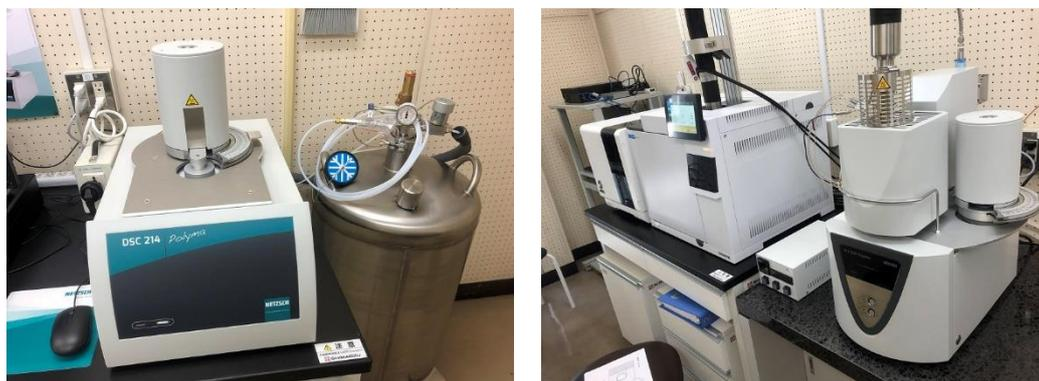
図 1. 左図: 示差走査熱量計, 右図: 示差熱重量測定装置(手前)と発生ガス分析装置(奥)
