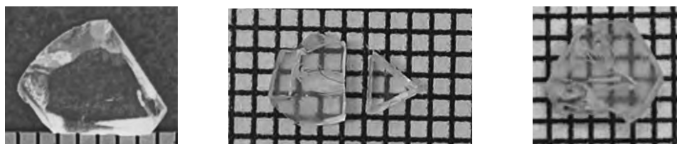
図4. 左から \text{Li}_2\text{CaSiO}_4 , \text{Ce}:\text{Li}_2\text{CaSiO}_4 , \text{Eu}:\text{Li}_2\text{CaSiO}_4 の単結晶試料
