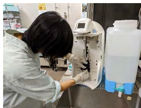
メンテナンス 超純水製造装置
