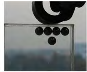
図4 xy 面内で磁気浮上するパチンコ玉 [18]
