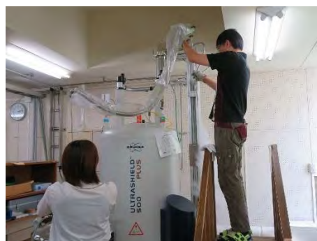
ヘリウム充填 核磁気共鳴装置(AV500)
