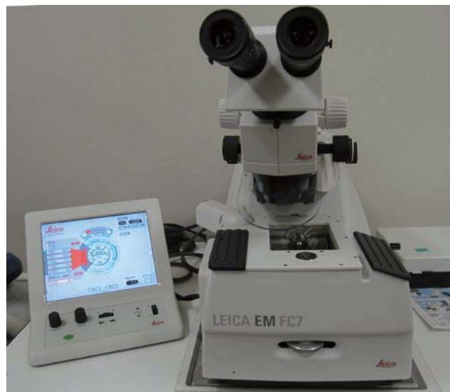
図3 Leica EM FC7(凍結ウルトラミクロトーム)
