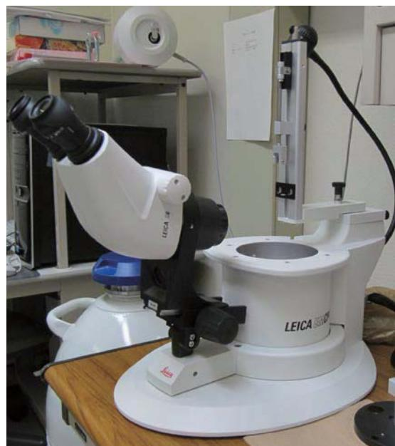
図2 Leica EM CPC(急速凍結装置)
