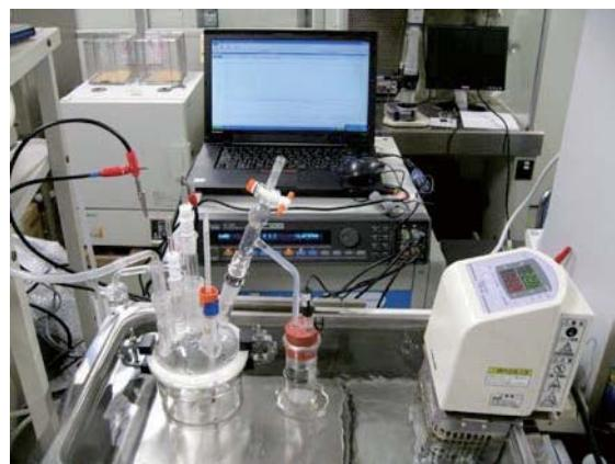
図11 ポテンショスタットによる電気化学試験
