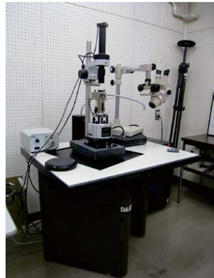
図1 AFM 装置(MultiMode8) 左:全体図, 右:測定部
