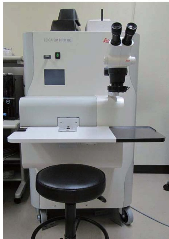
図 1 Leica EM HPM100(高圧凍結装置)
