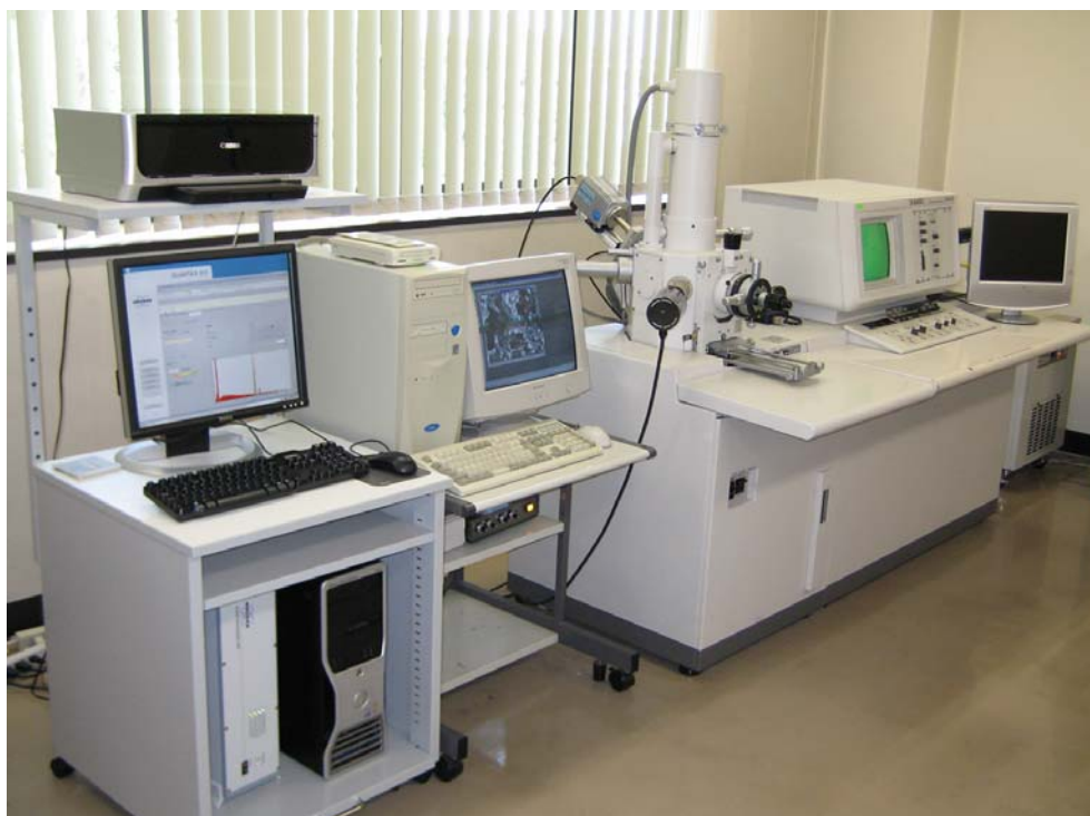
図1 S-2400型走査電子顕微鏡とX線微小領域元素分析デジタル解析システム
