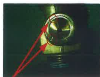
口金の溝を横断する傷がある
