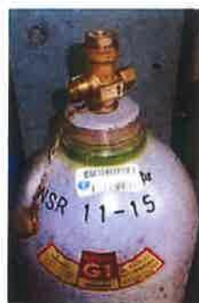
スピンドルが折れた容器弁
