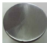
切削、研磨した試料
