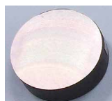
切削、研磨した試料
