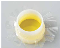
底面にフィルムを貼った試料容器に入れる
