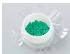
底面にフィルムを貼った 試料容器に入れる
